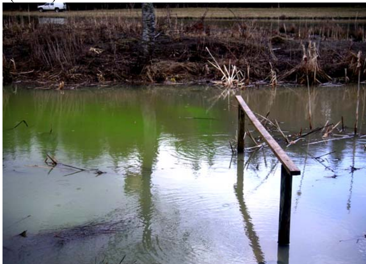
Bild 1. Färgämnet uranin ca en timme efter försöket startades 18 april 2006, dämnet (mitt för träkonstruktionen på bilden) vid våtmarkens inlopp pressade tillbaka vattnet till andra sidan ön (foto Helena Aronsson, SLU).
