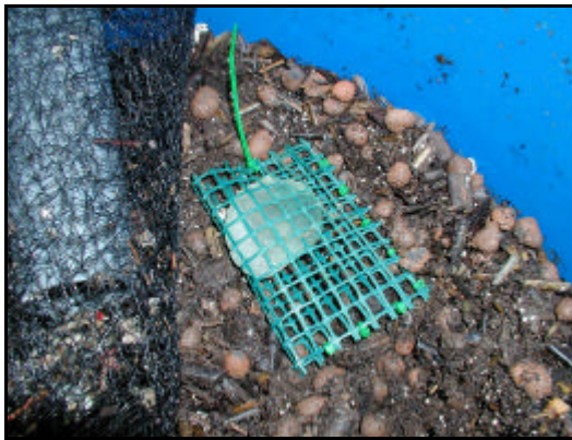
Figur 11. Fettnedbrytningstest i mullfilter.
