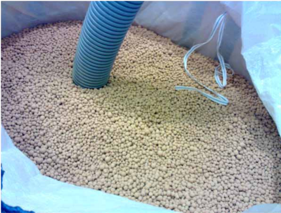
Figur 6. Tömning av fosforfiltermaterial med slamsug.
