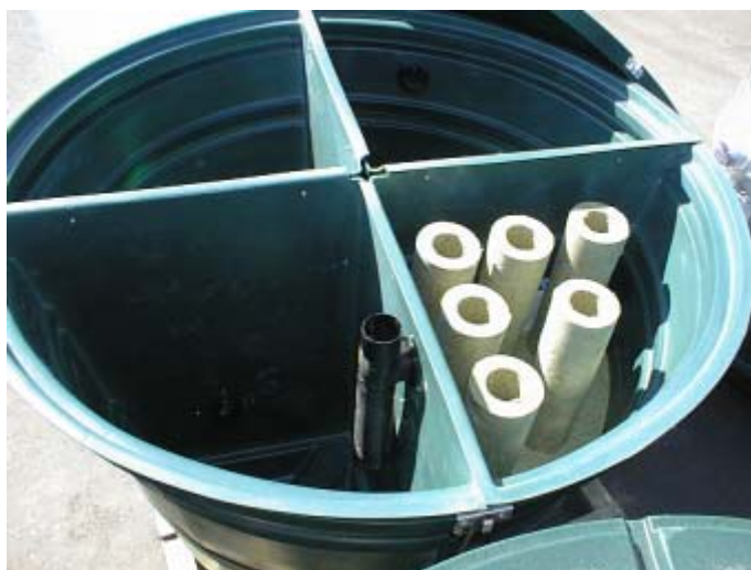
Green Rock 10S. De tre första kammarna fungerar som slamavskiljare, och i den tredje sitter ett biofilter av mineralull.
