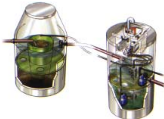
Figuren visar en slamavskiljare kompletterad med ett biologiskt och kemiskt steg för behandling av avloppsvatten från ett hushåll.
