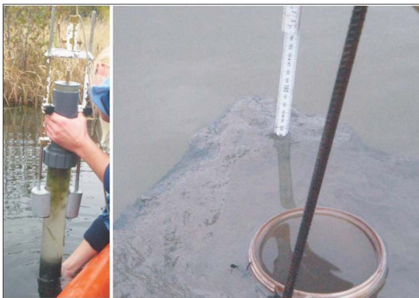
Figur 2-2 En rörhämtare av Willnertyp användes för insamling av ostörda sedimentprov (t.v.) och sedimentfällor (t.h.) användes bland annat för studier av uppbyggnadshastighet och omflyttning av sediment.
