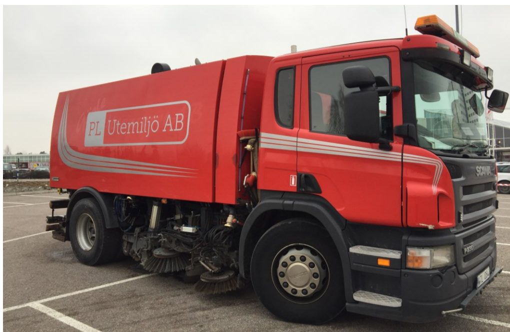
Figur 4. Sopsugmaskin som användes för rengöring.
