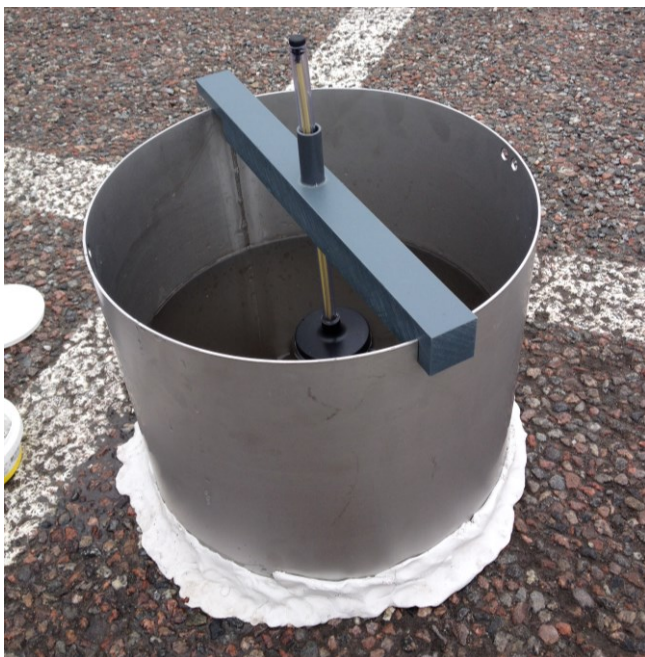
Figur 2. Bild på enkelring-infiltrometer under infiltrationsmätning.
