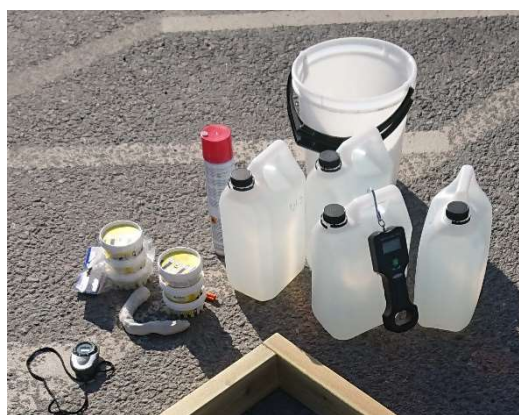
Figur 6. Övrigt material som användes till infiltrationsförsöken: tidtagarur, sanitetskitt, markeringsfärg, 10 dm 3 hinkar, fiskevåg och medtaget vatten i dunkar.
