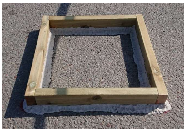
Figur 7. Ram för infiltrationsförsök monterad och tätad på den permeabla asfalten.
