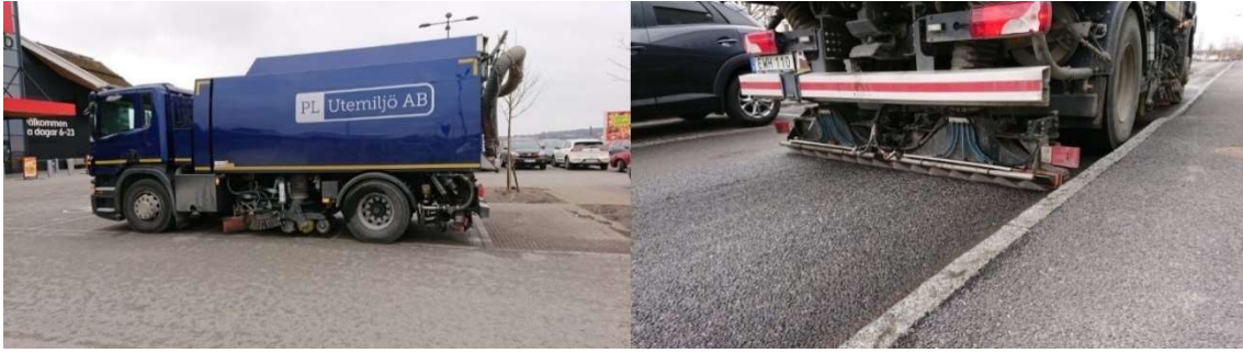
Figur 8. T.v. lastbilen som rengjorde den permeabla asfalten med högtryckstvätt och vakuumsug. T.h. rengöringsmunstycke med högtryckstvätt och vakuumsug.
