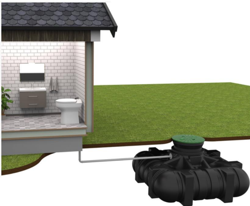
Figur 1. Figuren illustrerar en avloppsanordning för källsorterat klosettavloppsvatten i en fastighet, med en extremt snålspolande toalett kopplad till sluten tank (Wostman u.å.b).
