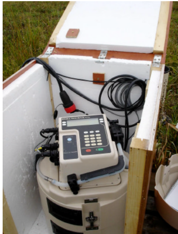
Provtagningsuppställning vid inloppet till våtmarken i Södra Stene. Provtagningsutrustningen är placerad i en isolerad låda och i anslutning till lådan står nederbörds-mätaren. Till höger syns den kombinerade flödesmätaren/provtagaren. Vattenprov samlas i en flaska i provtagarens underdel.
