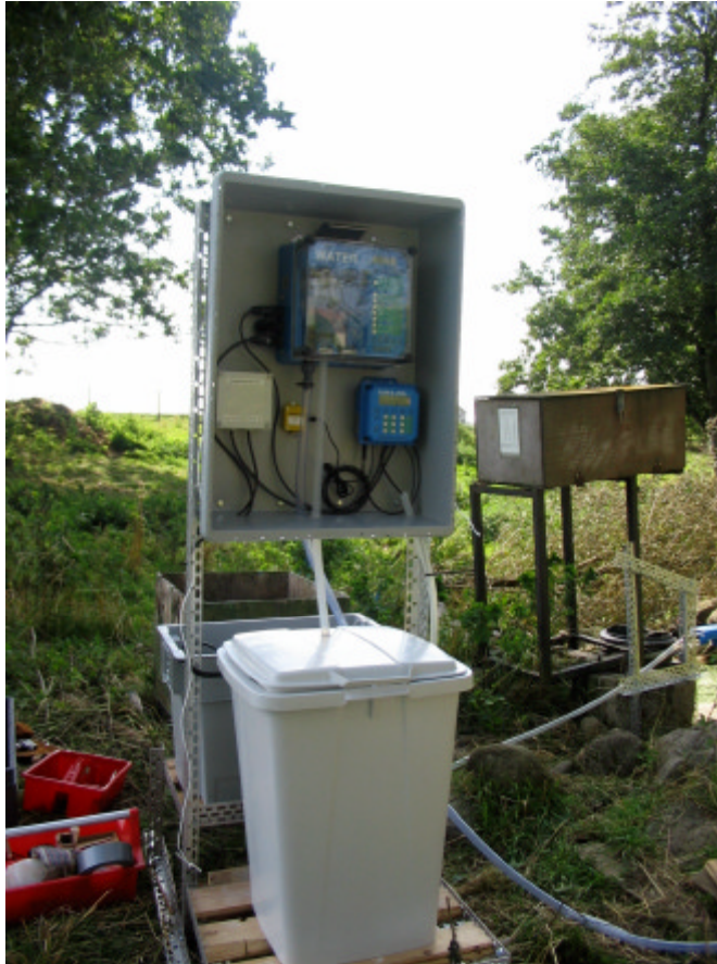
Ultraljudsgivaren mäter nivån till vattenytan. Bakom givaren syns plaströret som skyddar flöte och motvikt till den mekaniska pegeln.
