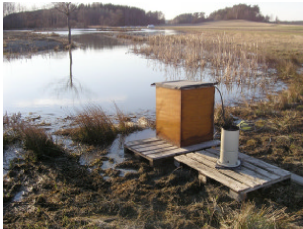
Provtagningsuppställning vid inloppet till våtmarken i Södra Stene. Provtagningsutrustningen är placerad i en isolerad låda och i anslutning till lådan står nederbörds-mätaren. Till höger syns den kombinerade flödesmätaren/provtagaren. Vattenprov samlas i en flaska i provtagarens underdel.
