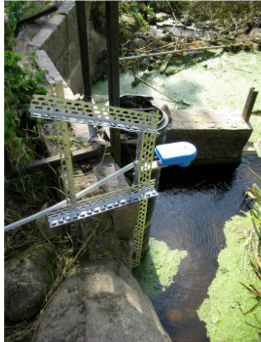
Ultraljudsgivaren mäter nivån till vattenytan. Bakom givaren syns plaströret som skyddar flöte och motvikt till den mekaniska pegeln.
