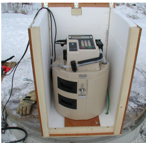
Figur 23. Kombinerad flödesmätare och vattenprovtagare vid våtmarkens utlopp. Foto: Jonas Andersson.
