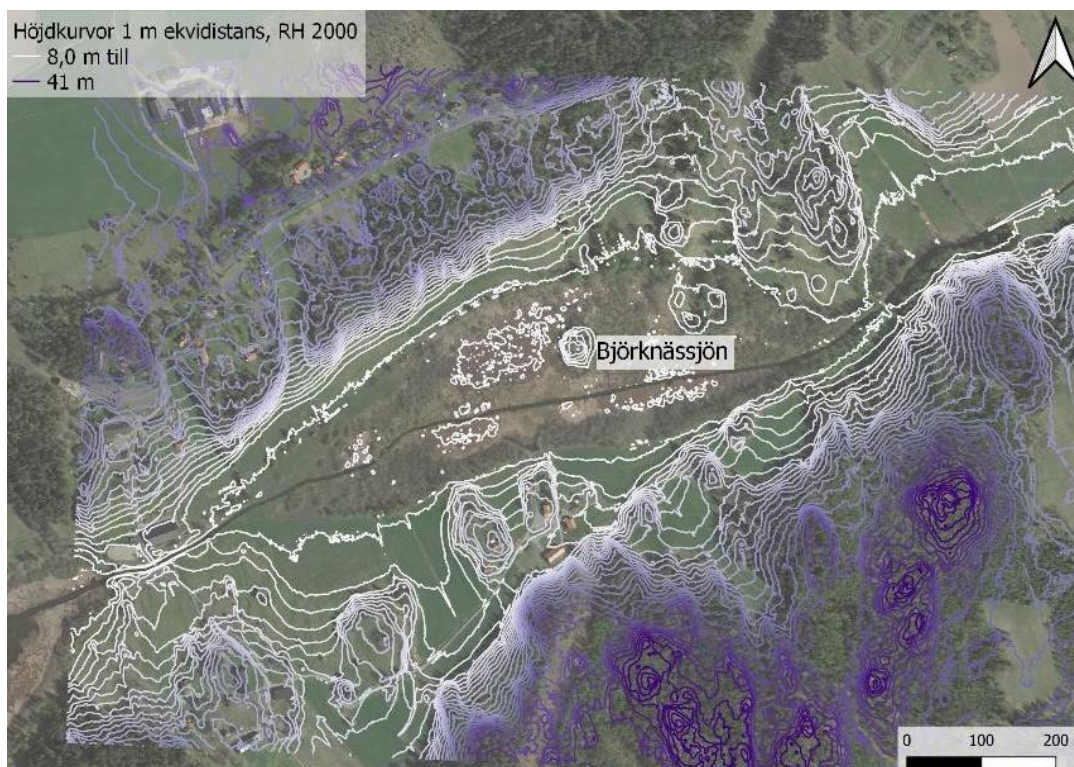
Figur 17. Topografiska förhållande vid Björknässjön (1 m ekvidistans) med höjder från © Lantmäteriet (u.å.) Höjdkurvan närmast den forna strandlinjen ligger på ca 9 m.
