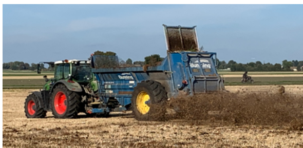
Tvåstegspridare har bättre förmåga att sönderdelas gödseln, större arbetsbredd och ofta också jämnare spridningsbild än traditionella spridare. Arbetsbredden kan i gynnsamma fall vara 12–16 m. Foto: Gunilla Frostgård
