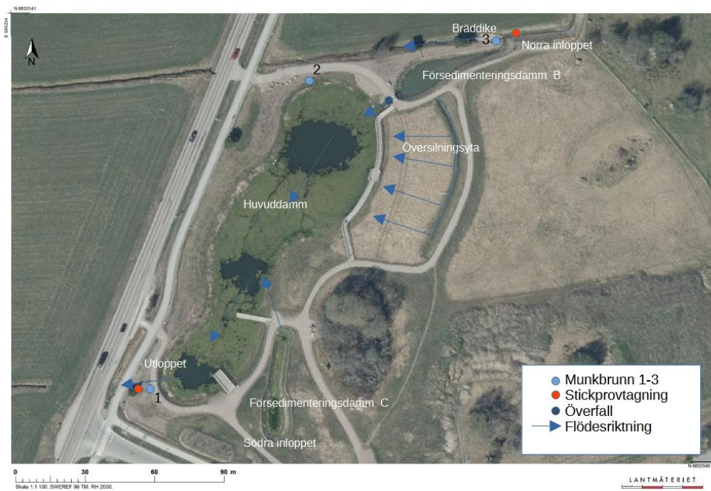
Figur 4. Provtagnings- och sensorpunkter samt flödesriktningar i Gottsunda dagvattenpark. Försedimenteringsdamm A är utanför bild i norr. Bakgrundskarta: © Lantmäteriet (u.å.).
